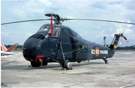
Conçu pour répondre à une demande émanant de l'US Navy, le Sikorsky S-58, hélicoptère de lutte anti sous-marine, vola pour la première fois le 8 mars 1954. Doté d'un moteur en étoile Wright R 1820, moteur d'avion monté à 39° situé dans le nez, d'un rotor quadripales et d'une structure de fuselage beaucoup plus résistante que celle du S-55 qui l'avait précédé, cet hélicoptère intéressa d'emblée l'US Army qui reçut les premiers exemplaires d'une version de transport, le H-34, en avril 1955.
